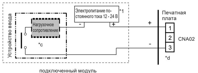
\*1: Обеспечьте питание 12 - 24 В постоянного тока. Выберите мощность электропитания с достаточным избытком для подключенной нагрузки. Не прилагайте напряжение выше 24 В к выводам 1-3.
